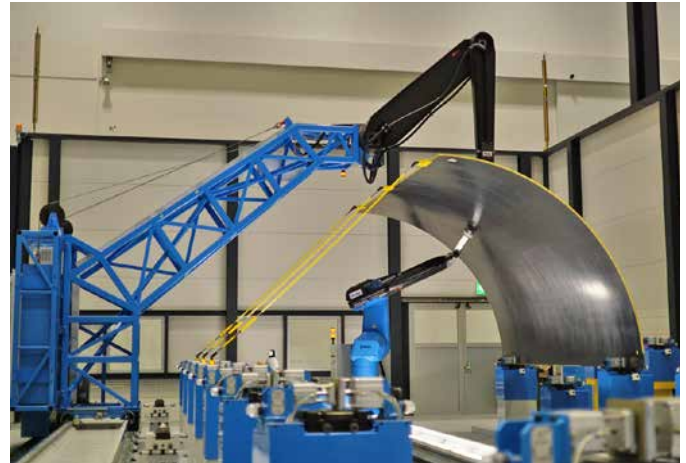
Bild 3: Der Prüfroboter im synchronen Betrieb mit dem kleineren Innenroboter.
